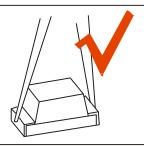
LED 的环氧树脂封装部分相当脆弱,请勿用坚硬、尖锐的物体刮、擦封装树脂部分。在用镊子夹取的时候也应当小心注意。
