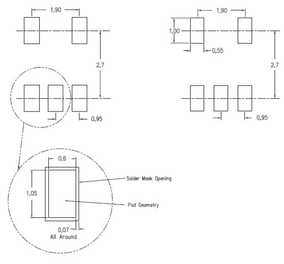
**RECOMMENDED PCB LAYOUT PATTERN** (Unit: mm)
