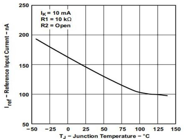
图 7. 基准输入电流与环境温度关系
