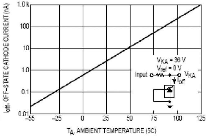
Figure 9.关闭状态阴极电流与环境温度关系
