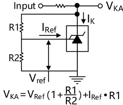
图 2.  $V_{KA} \geq V_{REF}$  测试电路
