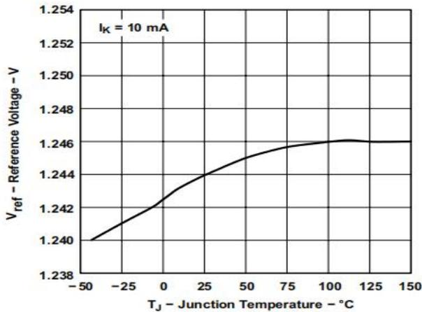
图 6. 基准输入电压与环境温度关系图
