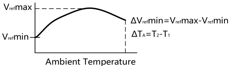
基准输入电压的平均温度系数由下列公式确定:
