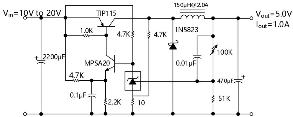
图 30. 高频降压开关转换器
