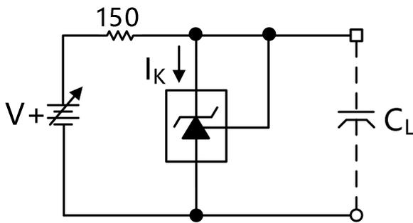
图 16. 稳定边界条件曲线 A 测试电路
