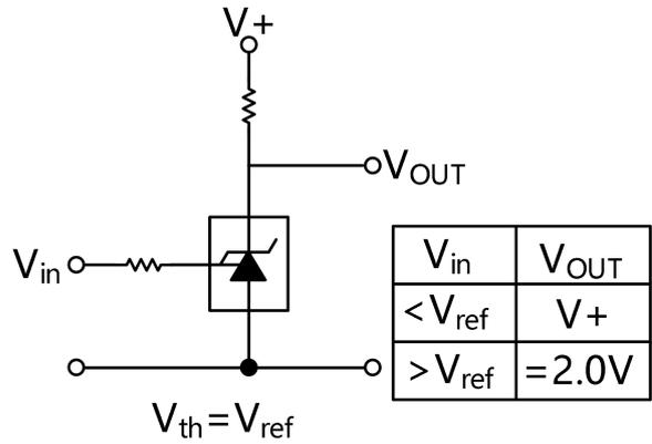
图 27. 温度补偿阈值单电源供电比较器
