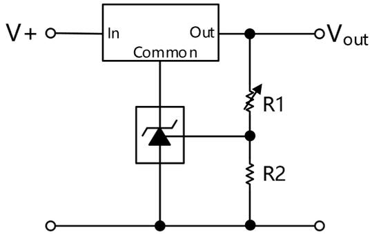
$$V_{out} = \left(1 + \frac{R1}{R2}\right) V_{ref}$$
