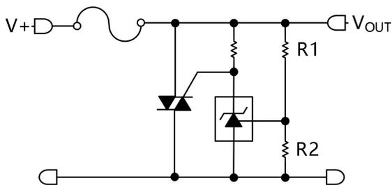
$$V_{OUT(trip)} = \left(1 + \frac{R1}{R2}\right) V_{ref}$$
