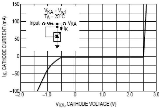
图 4. 阴极电流与阴极电压的关系
