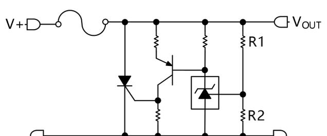
$$V_{OUT(trip)} = \left(1 + \frac{R1}{R2}\right) V_{ref}$$
