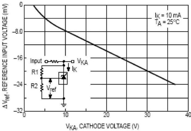
图 8.基准输入电压变化与阴极电压关系
