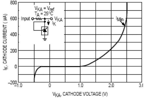
图 5. 阴极电流与阴极电压的关系
