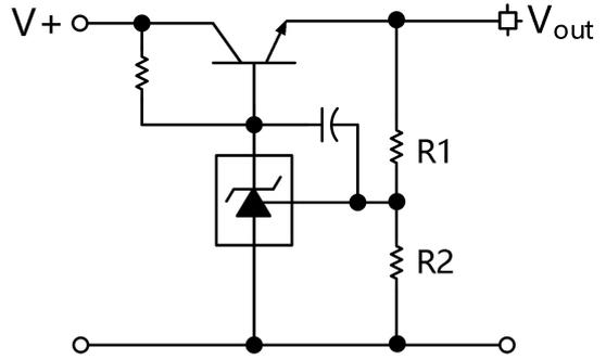
$$V_{out} = \left(1 + \frac{R1}{R2}\right) V_{ref}$$
