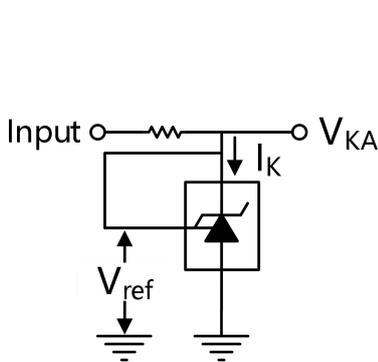
图 1.  $V_{KA} = V_{REF}$  测试电路
