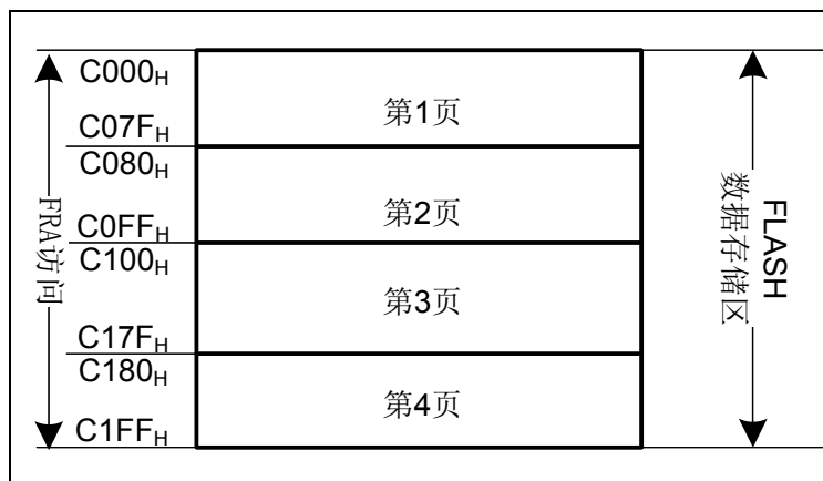
图 3-2 FLASH 数据存储区寻址空间映射图
