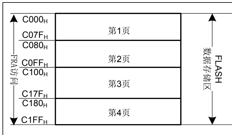
图 3-2 FLASH 数据存储区寻址空间映射图
