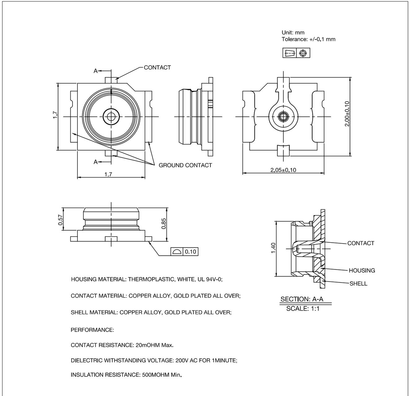
图 10: 外部天线连接器尺寸图
