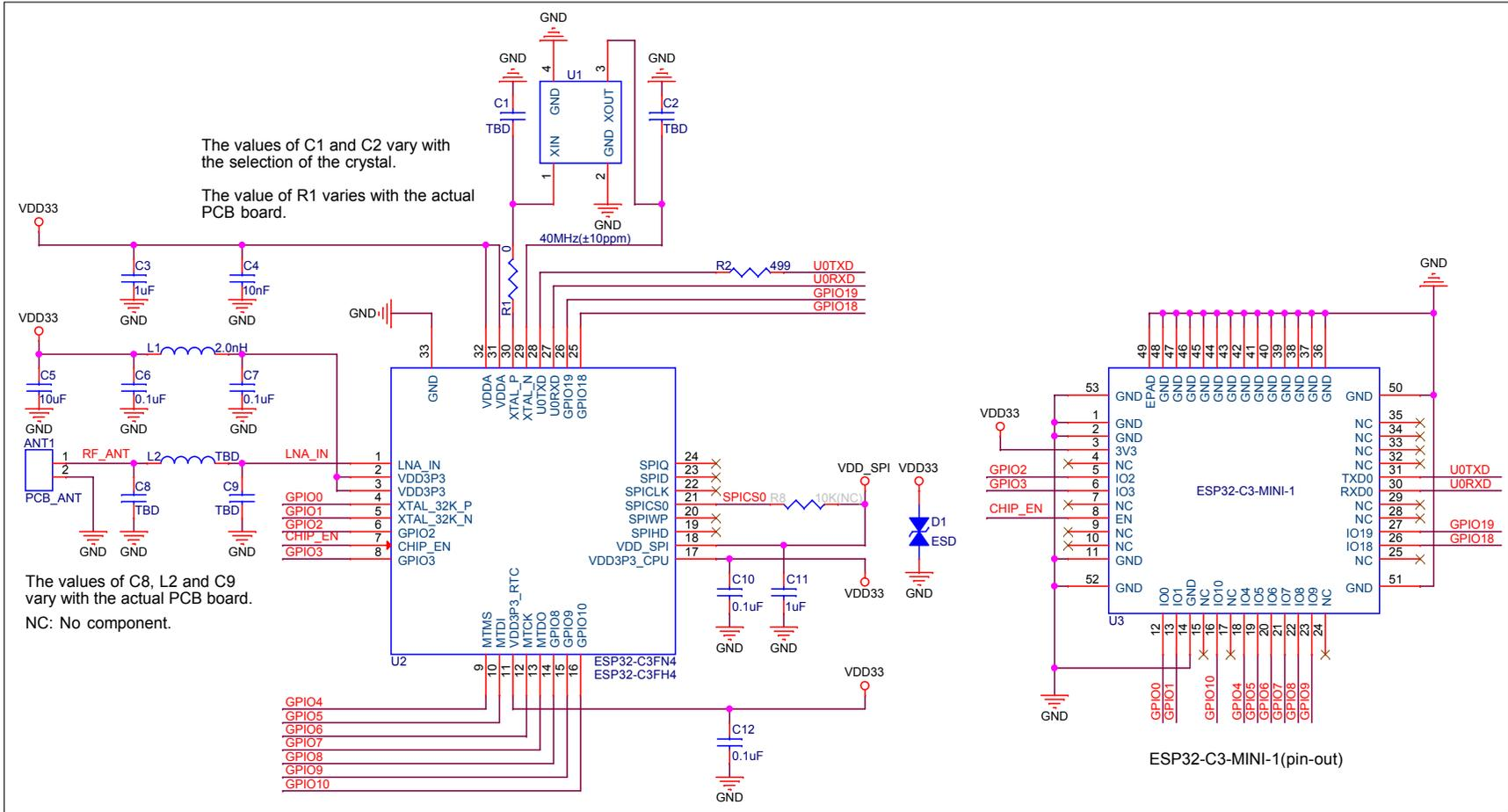
图 5: ESP32-C3-MINI-1 原理图
