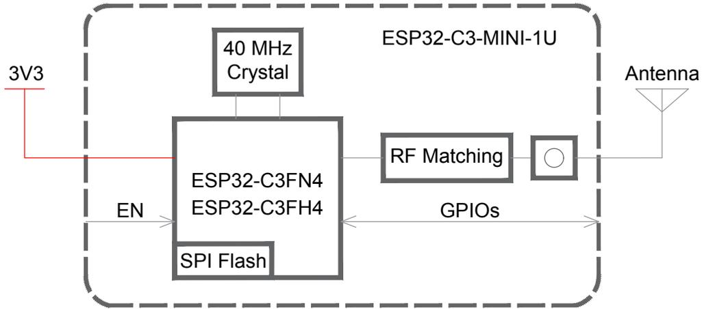
图 2: ESP32-C3-MINI-1U 功能框图
