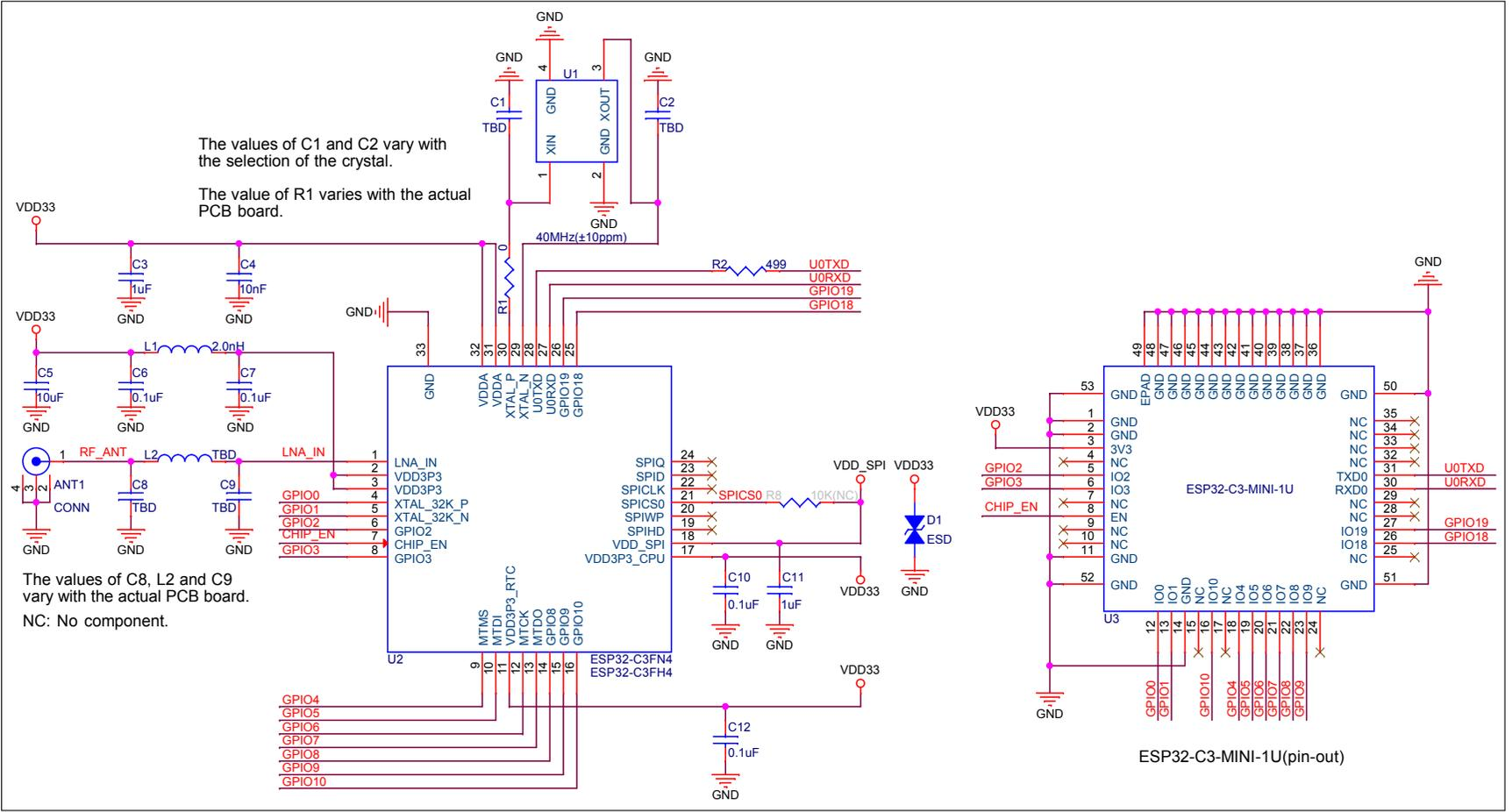
图 6: ESP32-C3-MINI-1U 原理图
