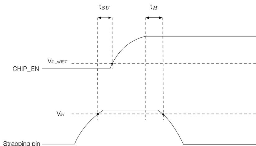
图 4: Strapping 管脚的时序参数图
