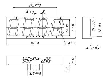
COMMON CATHODE 1 ANODE E ANODE DANODE DP 3 ANODE CANODE G5 6 COMMON CATHODE D4 ANODE BCOMMON CATHODE D3 9 COMMON CATHODE D2 10 ANODE F 11 ANODE A 12 COMMON CATHODE D1
