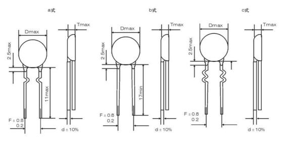
注:引脚距離和引綫形式常規按EIA和JIS的標准執行。同時我們可以根據客户要求,做出符合客户使用的引脚距離和引綫形式。 NOTE: Lead style and distance are fit of JIS and EIA standard. Other we can produce which customers require.
