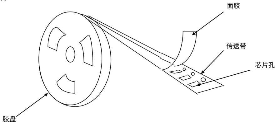
\* 塑胶带尺寸结构(适合 '0505、1111' 型产品)
