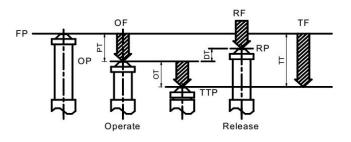
操作力 回复力 全行程力 自由位置 Operating Force Release Force OF: RF: TF: Total travel Force FP: Free Position OP: Operating Position 动作位置 TTP: Total Travel Position RP: Release Position PT: Pre Travel 行程 OT: 超行程 Over travel
