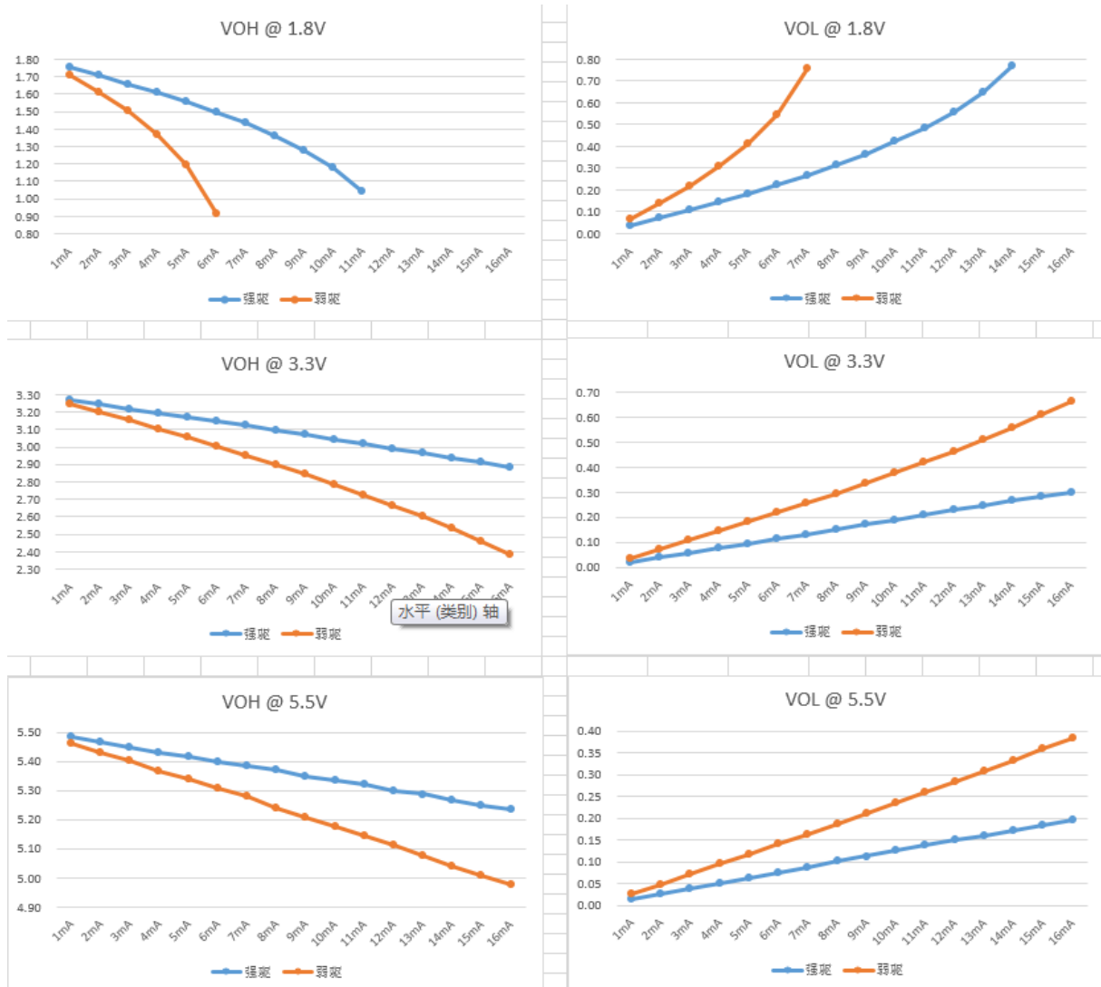
图 7-2 输出端口 VOH/VOL 实测曲线
