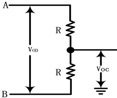
图 1 驱动器直流特性测试负载
