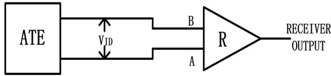
图 9 接收器传输延时测试电路
