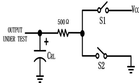
图 4 驱动器使能/关断 开关特性测试负载
