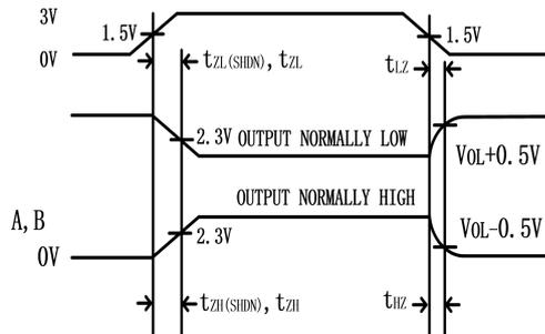
图 6 驱动器使能/关断时序
