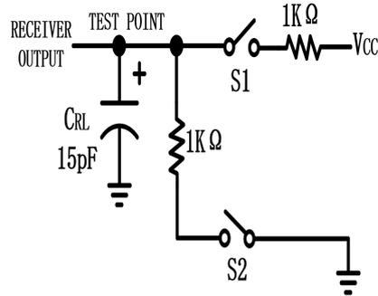
图 2 接收器使能/关断 开关特性测试负载
