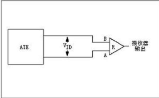
图 8: 接收器传播延时测试电路
