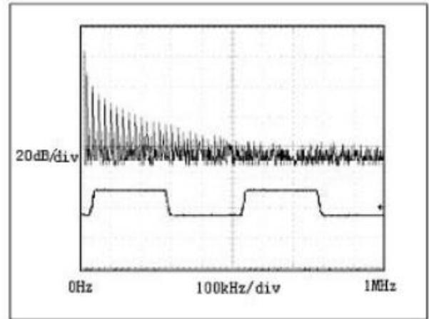
图 9: 传输 20kHz 信号时 MAX490E 驱动器
