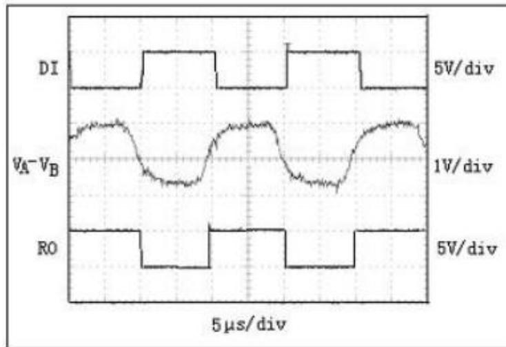
图 10: 在 50kHz 时驱动 4000 英尺的电缆
