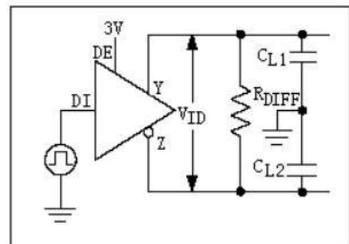
图 5: 驱动器时序测试电路
