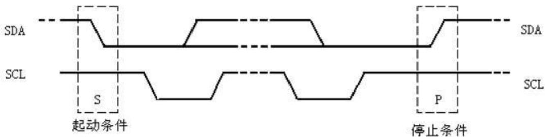
图 6. I2C 总线启动和停止波形图
