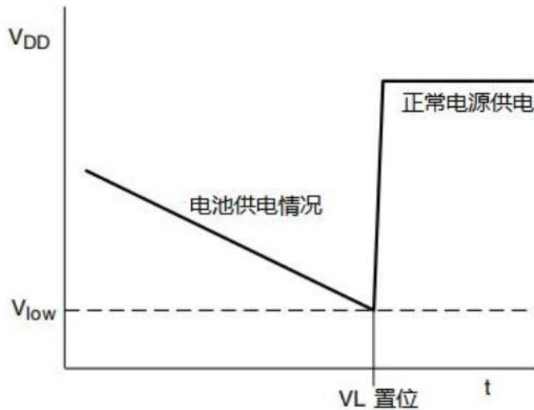
图 3. 低电压检测
