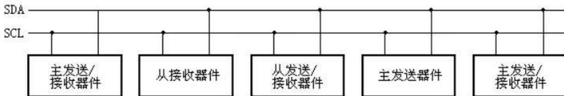
图 5. I2C 总线系统配置图
