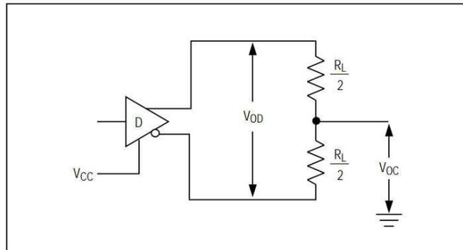
图 2 驱动器直流测试负载
