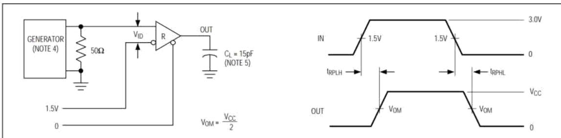
图 7 接收器传播延时测试电路
