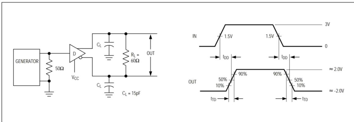
CL 包含探针以及杂散电容 (下同)
