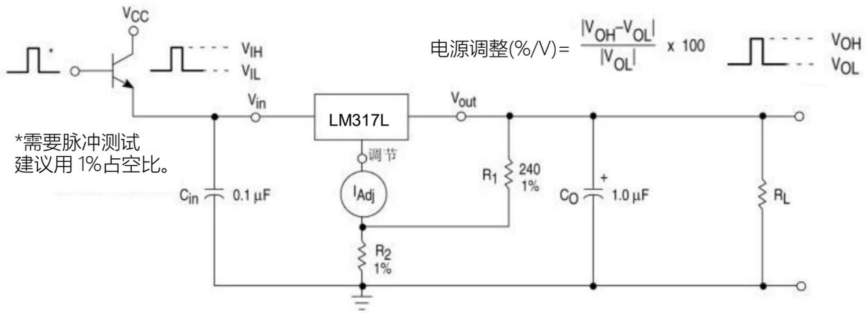
图 2.负载调整率和 $\Delta I_{Adj}$ /负载测试电路
