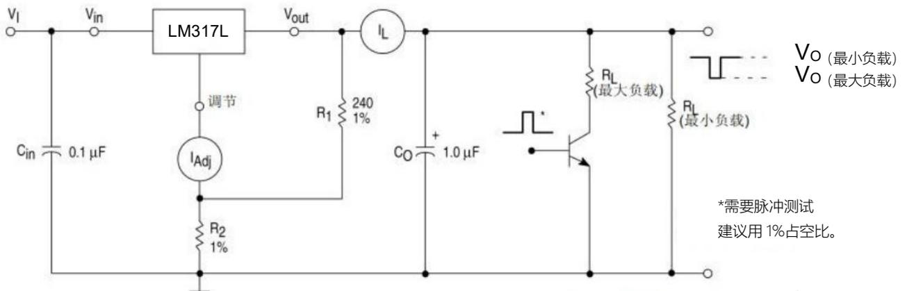
负载调整率 (mV) =  $V_o$  (最小负载率) -  $V_o$  (最大负载率)
