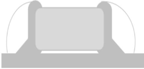
B. 焊料太少固定力量不足，可能会引起电容芯片与线路接触不良。
