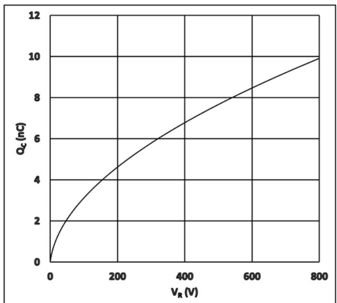
图 4 典型存储电荷与反向电压曲线
