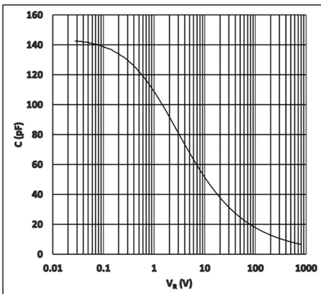
图 3 典型电容与反向电压曲线
