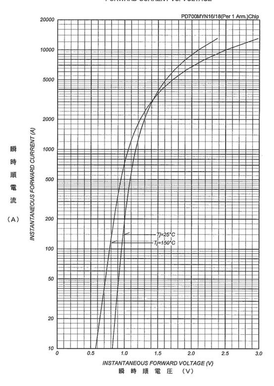
順電圧特性 FORWARD CURRENT VS. VOLTAGE
