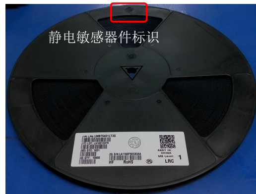
13英寸卷盘标签张贴及QA印章位置
