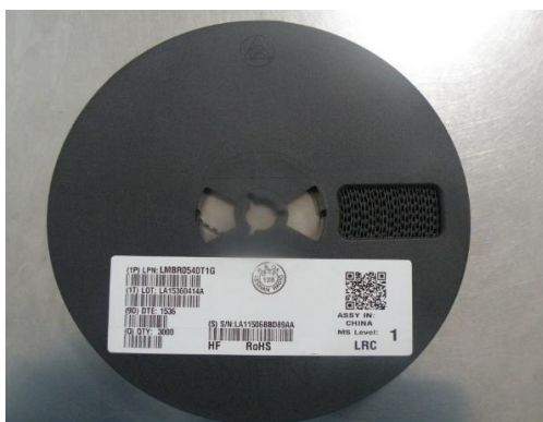
7英寸卷盘标签张贴及QA印章位置
