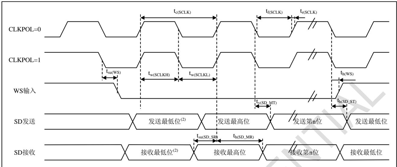
1. 测量点设置于CMOS电平：0.3V<sub>DD</sub>和0.7V<sub>DD</sub>。
