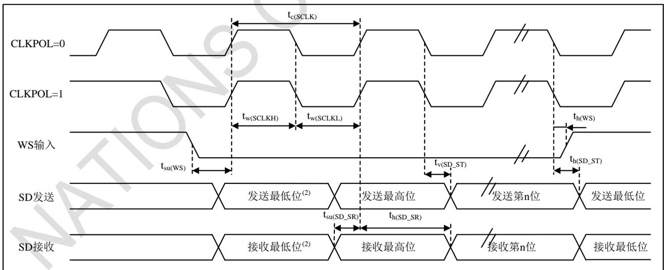
1. 测量点设置于CMOS电平:  $0.3V_{DD}$ 和 $0.7V_{DD}$ 。
