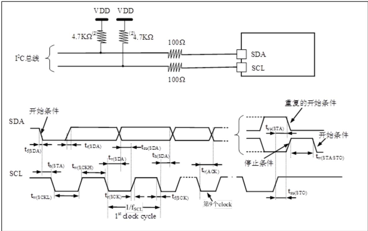
1. 测量点设置于CMOS电平：0.3V<sub>DD</sub>和0.7V<sub>DD</sub>。
