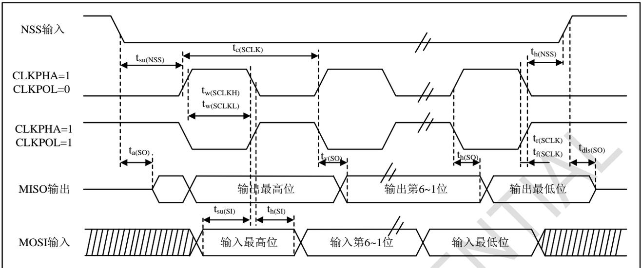
1. 测量点设置于CMOS电平：0.3VDD和0.7VDD。
