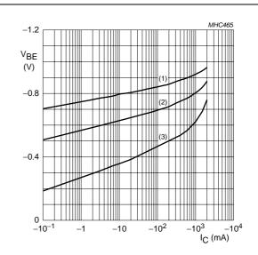
**TR2 (PNP);**  $V_{CE} = -5 \text{ V}.$
