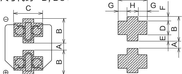
(推荐电路板焊盘尺寸)
