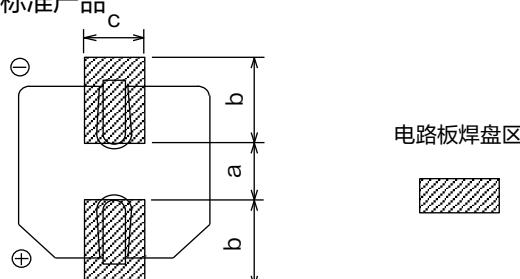
(推荐电路板焊盘尺寸)
