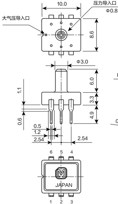
印刷电路板推荐加工图 (BOTTOM VIEW)
