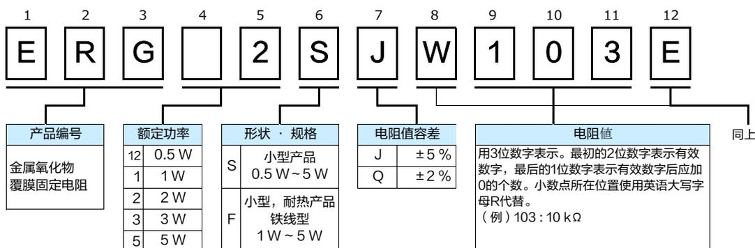
例2 所示为额定功率2 W 小型金属氧化物覆膜固定电阻，其电阻值为10 kΩ，电阻值容差为±5 %，异型径向带状包装。
