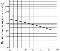
Ambient temperature T<sub>a</sub> (°C)
