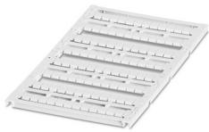
用于端子的标记条，可订购：标签纸，白色，根据客户要求标识，安装方式：卡接到扁平式标记槽，适用的模块宽度：5.2 mm，标识区域大小：4.6 x 5.1 mm，标签数：96
