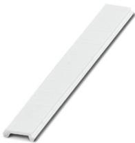
快速标记条，扁平型，接头，白色，未标记，适用的打印机：PLOTMARK，CMS-P1-PLOTTER，安装方式: 已卡接，适用的模块宽度：5 mm，标识区域大小: 5.1 x 5.2 mm，标签数: 10
