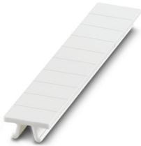
快速标记条，接头，白色，未标记，适用的打印机：PLOTMARK，CMS-P1-PLOTTER，安装方式：已卡接，适用的模块宽度：5.2 mm，标识区域大小：5.1 x 10.5 mm，标签数：10
