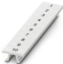
快速标记条，白色，纵向打印: 连续编号1 ... 10、11 ... 20等，直至491 ... 500，安装方式: 已卡接，适用的模块宽度: 5.2 mm，标识区域大小: 5.15 x 10.5 mm
