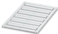
用于端子的标记条，标签纸，白色，未标记，适用的打印机：TOPMARK NEO，TOPMARK LASER，BLUEMARK ID COLOR，BLUEMARK ID，BLUEMARK CLED，THERMOMARK PRIME，THERMOMARK CARD 2.0，THERMOMARK CARD，安装方式：已卡接，适用的模块宽度：5.2 mm，标识区域大小：4.4 x 4.7 mm，标签数：72
