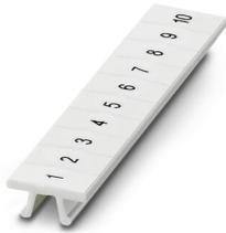
快速标记条，接头，白色，标识，横向打印: 连续编号1 ... 10、11 ... 20等，直至491 ... 500，安装方式: 已卡接，适用的模块宽度: 5.2 mm，标识区域大小: 5.15 x 10.5 mm，标签数: 10
