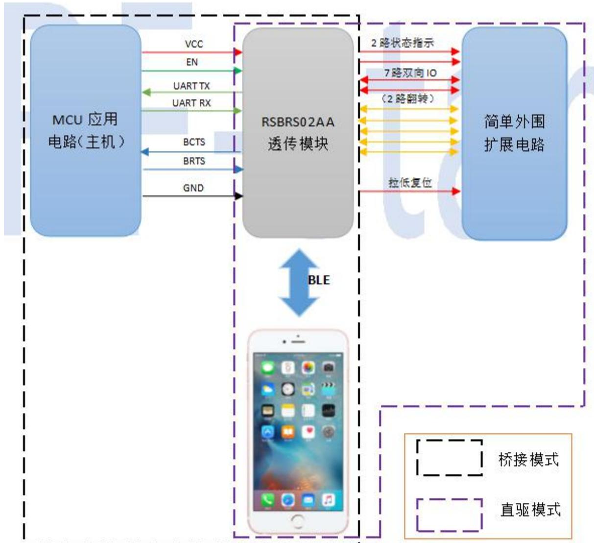
模块桥接模式和直驱模式示意图
