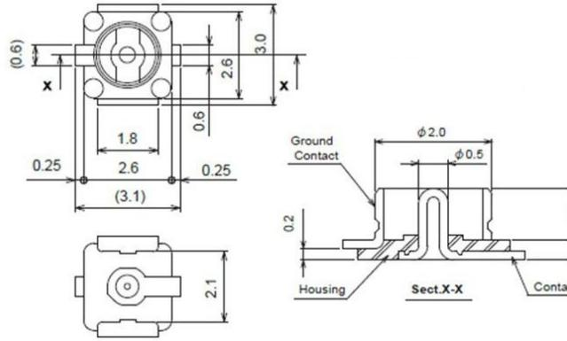
2、IPEX 线端的规格如下图所示：
