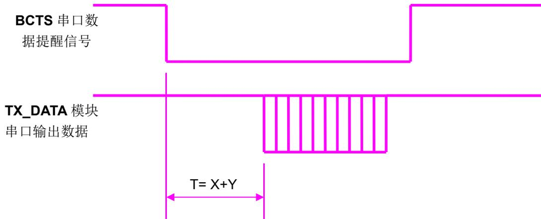
模块串口输出数据延时设定示意图
