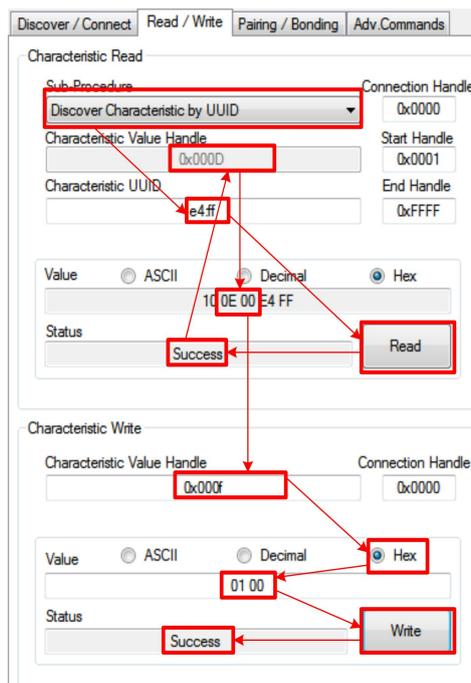
模块发送至移动设备使用**串口数据通道**，对应特征值(通道)的 UUID 如下：
