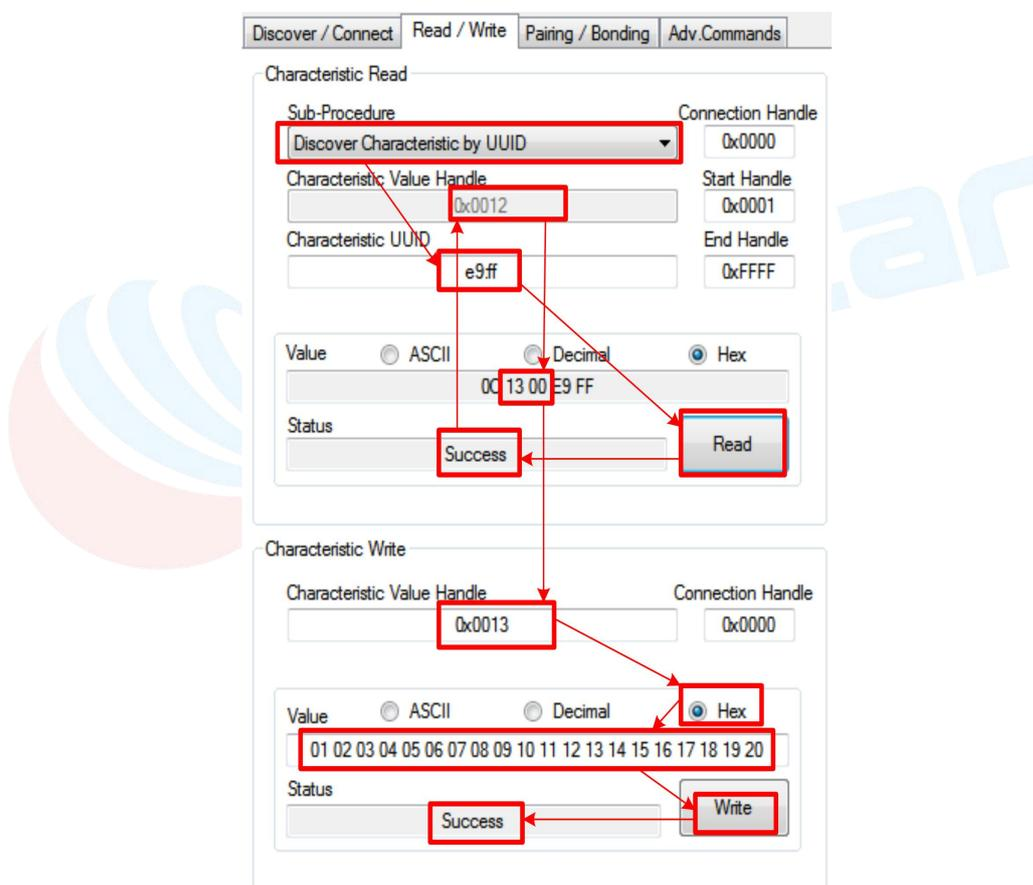
注：可写入 1-20 个字节到模块，但不能超过 20 个字节，因此在手机端编程时，必须自行分包发送，每包长度不得超过 20 字节。
