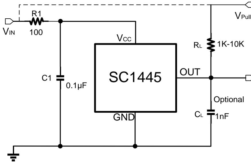
SC1445 内部有电压调节器，可以在宽供电电压范围内工作。当器件工作于非稳压电源供电的应用时，必须在外部添加瞬态保护。对于使用稳压电源线路供电的应用，可能仍然需要 EMI/RFI 保护。强烈建议电源端与接地端使用外接电容，可降低外部噪声及内部斩波频率技术产生的噪声，建议靠近芯片 V<sub>CC</sub> 电源端并联 C<sub>1</sub> 电容到地，其典型值为 0.1μF。同时在外部的可选配串联电阻 R<sub>1</sub> 其典型值为 100Ω。输出电容 C<sub>L</sub> 用作输出滤波，典型值为 1nF。
