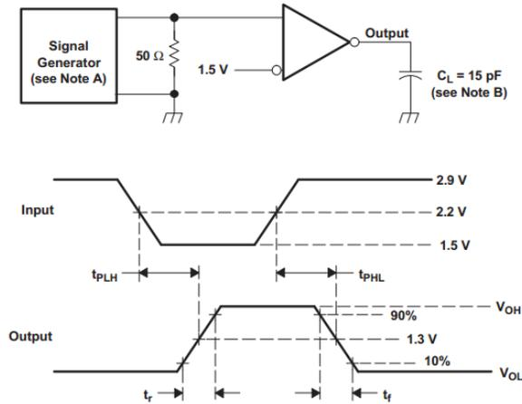
A、输入脉冲产生器特点：脉冲重复速率  $PRR \leq 500\text{KHz}$ ，50%占空比， $t_r < 6\text{ns}$ ， $t_f < 6\text{ns}$ ， $Z_o = 50\Omega$
