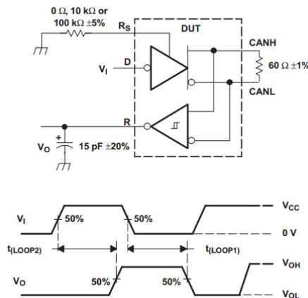
A、输入脉冲产生器特点：脉冲重复速率  $PRR \leq 125\text{KHz}$ ，50%占空比， $t_r < 6\text{ns}$ ， $t_f < 6\text{ns}$ ， $Z_o = 50\Omega$
