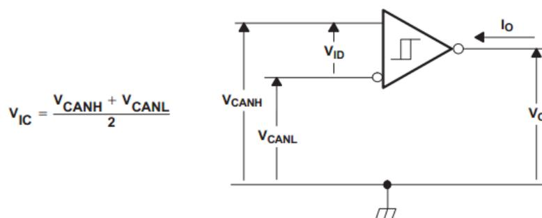
**图 5 接收器电压与电流定义**
