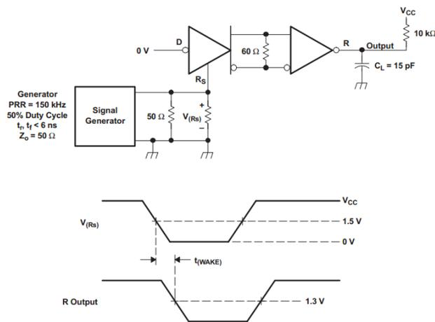
**图 7  $t_{(WAKE)}$ 测试电路与电压波形**
