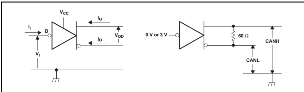
图 1 驱动器电压、电流测试定义
