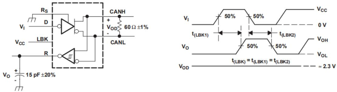
A、输入脉冲产生器特点：脉冲重复速率 PRR=125KHz，50%占空比， $t_r < 6ns$ ， $t_f < 6ns$
