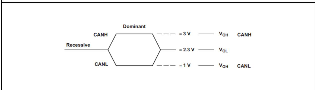
**图 2 总线逻辑电压定义**
