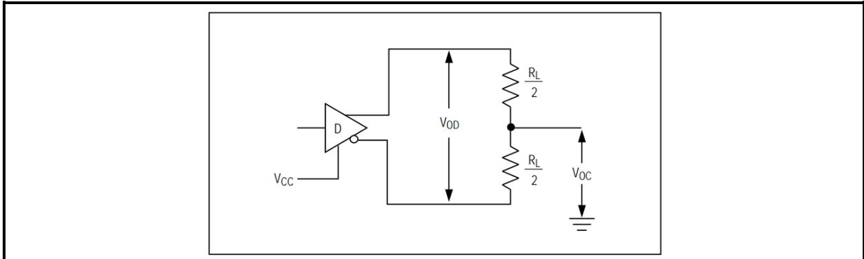
**图 2 驱动器直流测试负载**
