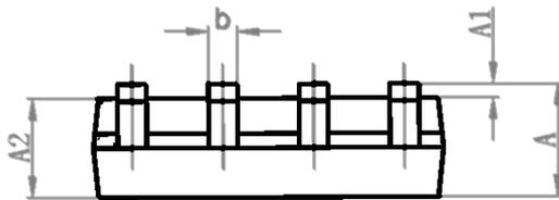
**MSOP8 /8μMAX / VSSOP8 外形尺寸**
