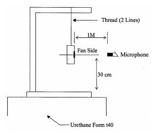
1 METER FROM MICROPHONE TO FAN INTAKE
