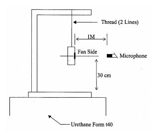
1 METER FROM MICROPHONE TO FAN INTAKE
