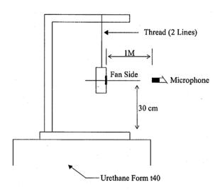
1 METER FROM MICROPHONE TO FAN INTAKE
