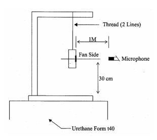
1 METER FROM MICROPHONE TO FAN INTAKE
