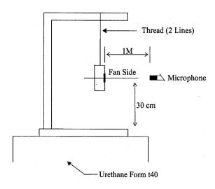
1 METER FROM MICROPHONE TO FAN INTAKE
