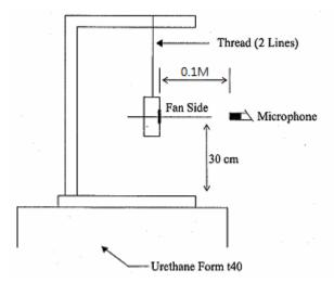
0.1 METER FROM MICROPHONE TO FAN INTAKE
