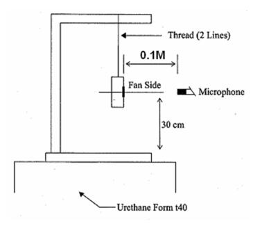
0.1 METER FROM MICROPHONE TO FAN INTAKE
