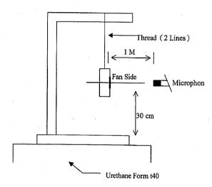
1 METER FROM MICROPHONE TO FAN INTAKE
