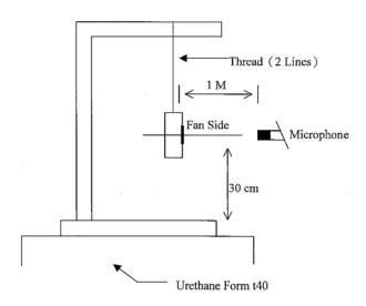
1 METER FROM MICROPHONE TO FAN INTAKE
