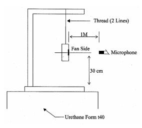
1 METER FROM MICROPHONE TO FAN INTAKE
