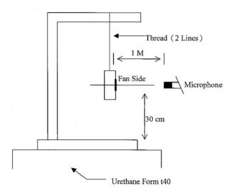
1 METER FROM MICROPHONE TO FAN INTAKE
