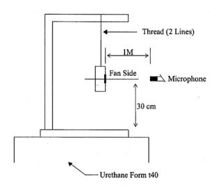
1 METER FROM MICROPHONE TO FAN INTAKE
