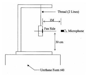
1 METER FROM MICROPHONE TO FAN INTAKE
