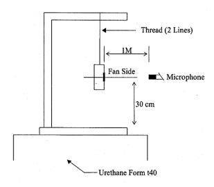
1 METER FROM MICROPHONE TO FAN INTAKE
