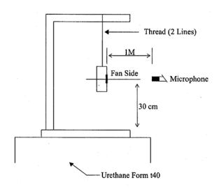
1 METER FROM MICROPHONE TO FAN INTAKE
