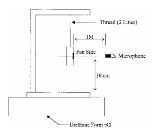
1 METER FROM MICROPHONE TO FAN INTAKE
