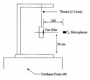
1 METER FROM MICROPHONE TO FAN INTAKE
