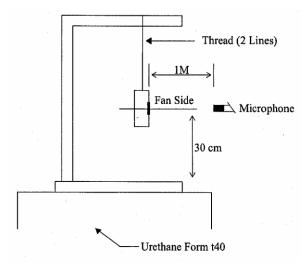
1 METER FROM MICROPHONE TO FAN INTAKE
